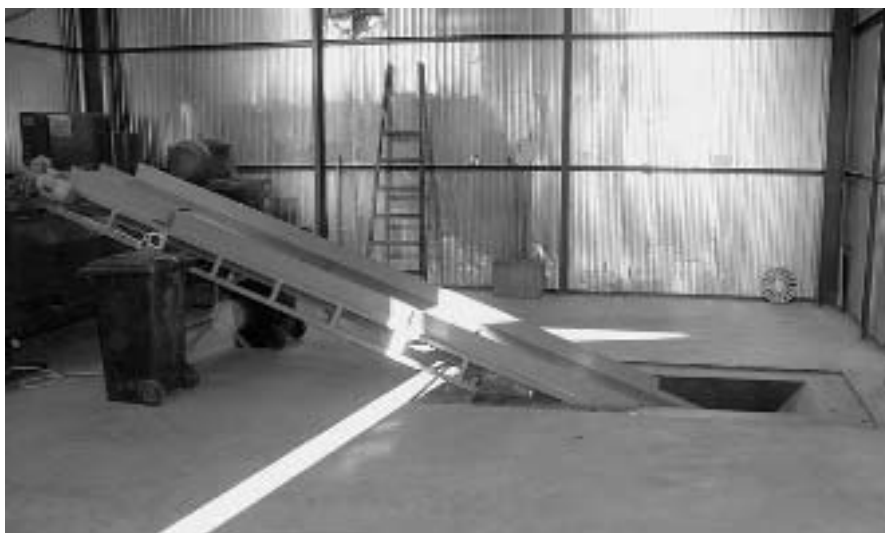
Dokončená instalace pásového dopravníku k lisu na papír
